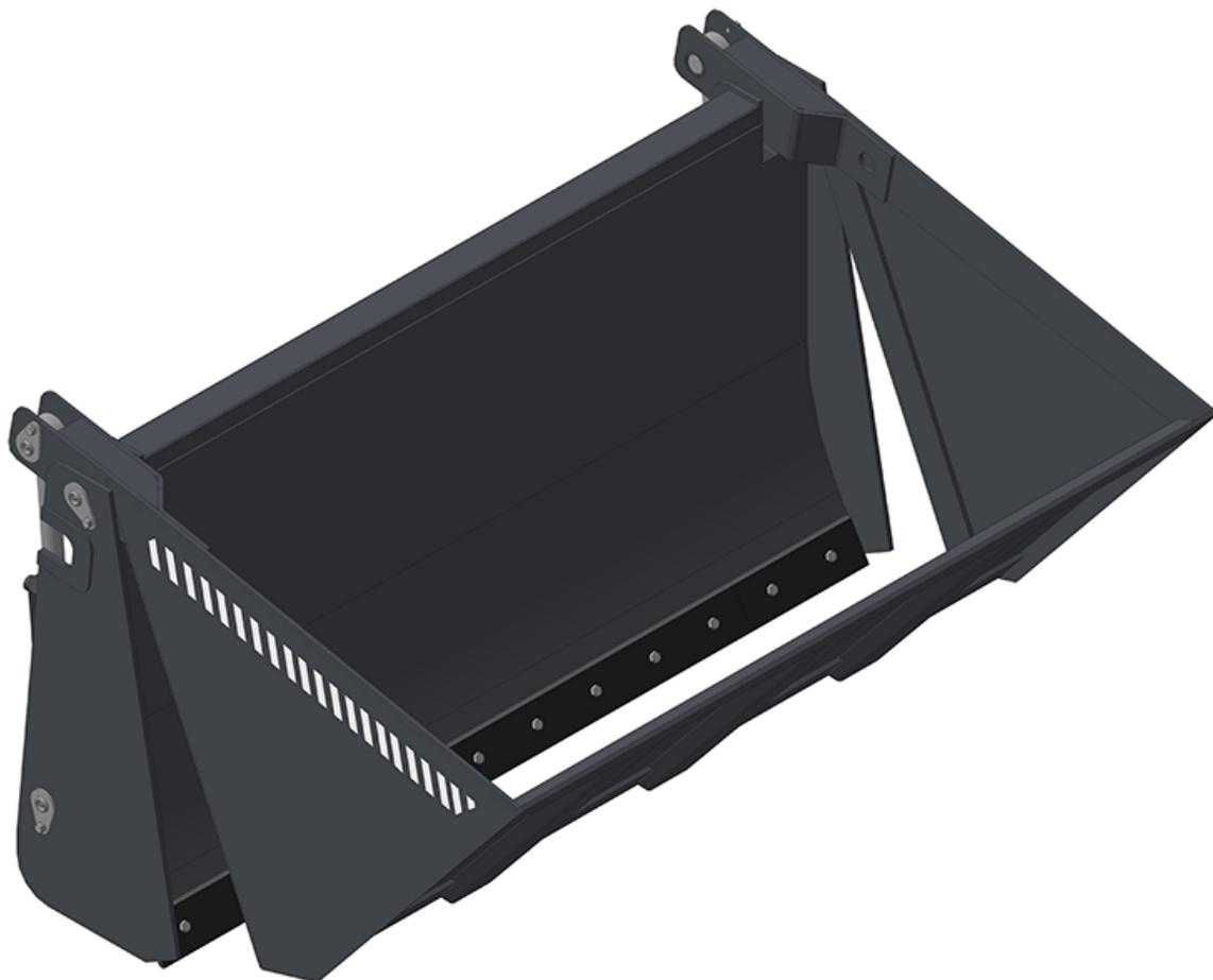
Универсальное устройство, которое одновременно является ковшом (в закрытом состоянии) и бульдозерным отвалом (в открытом состоянии). Ковш применяется для погрузки и перемещения сыпучих и малосыпучих материалов удельным весом до 15 м<sup>3</sup>. Отвал для выполнения малообъемных планировочных работ на грунтах I-II категорий, расчистки дорог от снега, и т.п.
