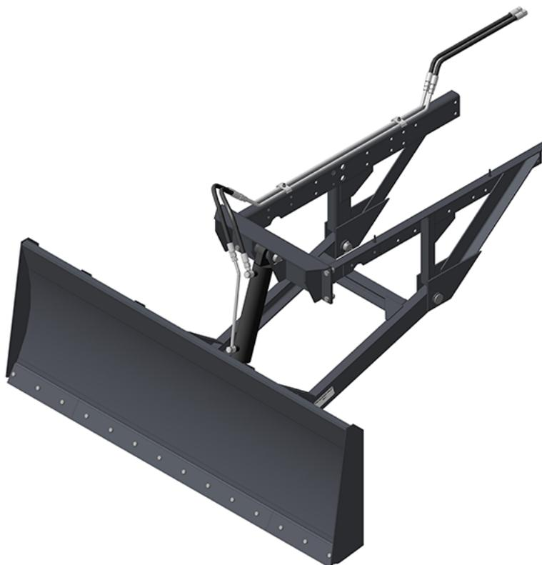
Отвал предназначен для выполнения малообъемных планировочных работ на грунтах I-II категорий, расчистки дорог от снега, уборки территории и других видов работ с мелкокусковыми сыпучими материалами. Отвал комплектуется металлическими ножами из стали 45.
